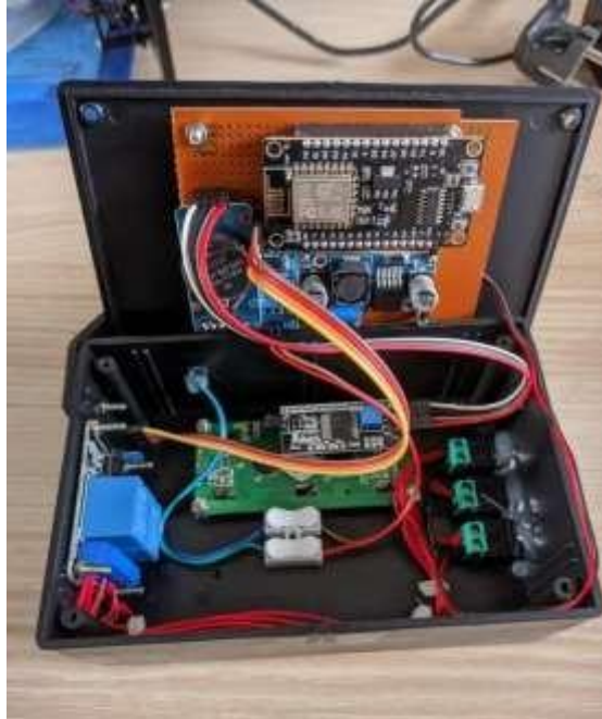
Gambar 6. Penempatan Komponen di dalam kotak kendali
